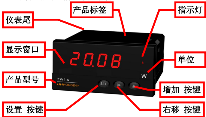
图 2 ZW16 单参数仪表图示
